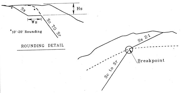
RATIO BREAK/BEDROCK TO SOIL DETAIL
